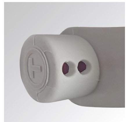
Agujeros de entrada sobredimensionados
